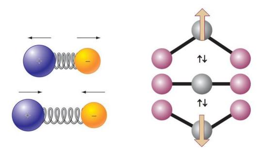
Variação do momento de dipolo elétrico com a vibração:
